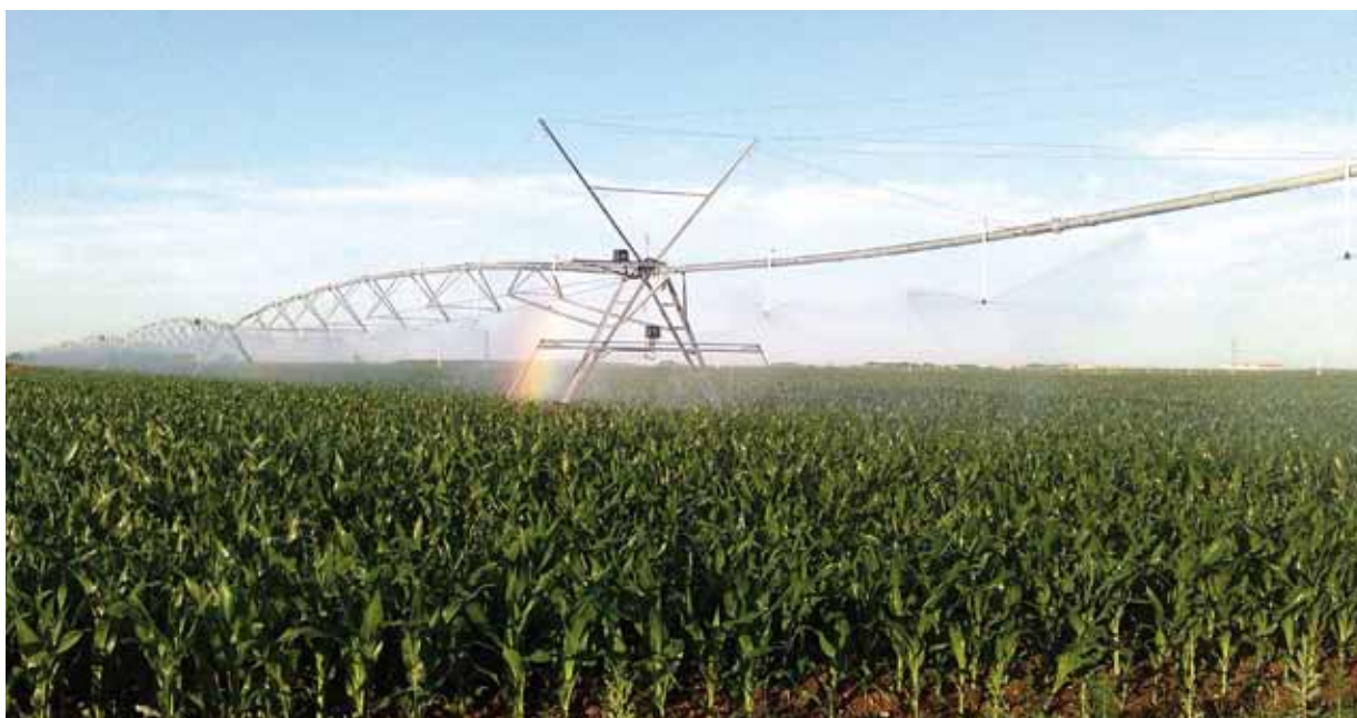
Sistema mecanizado de riego por aspersión (pivote).
