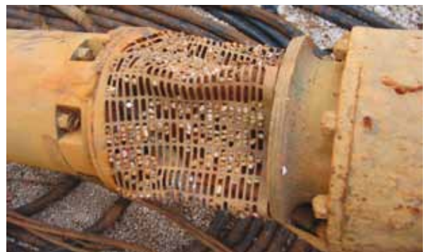
Obstrucción de la rejilla de aspiración en bomba sumergible.
